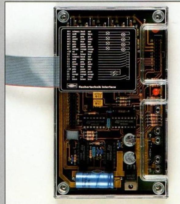
Verbindung zwischen Computer und fischartechnik Modellen. 8 Digital-Eingänge. 2 Analog-Eingänge. 4 Motor-Ausgänge (max. 12 V $\overline{\text{---}}$ , 1,0 A) Zahl der Ein- und Ausgänge durch 2. Interface erweiterbar.
