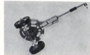
Abb. 10: Vorderräder: Drehschemel mit Einzelradlagerung auf getrennten Achsen.
