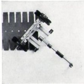
Abb. 2b: Drehbalken mit beweglicher Deichsel
