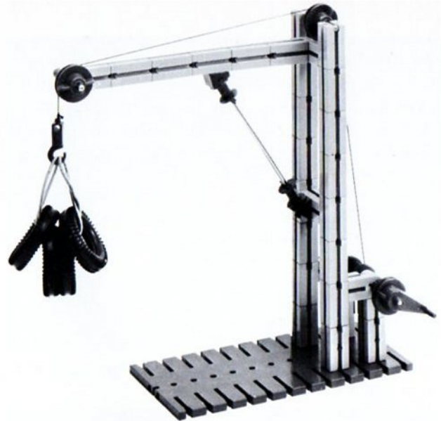
Funktionsmodell eines Krans mit starrem Ausleger und Hubwerk zur Verringerung des Kraftaufwandes
