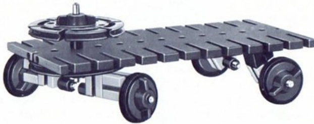
Bild VI 1: Seifenkiste mit tiefliegendem Schwerpunkt, „Lenkstange“, einfachem Seilzug und Bodenschleifbremse.
