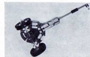
Abb. 10: Vorderräder: Drehschemel mit Einzelradlagerung auf getrennten Achsen.
