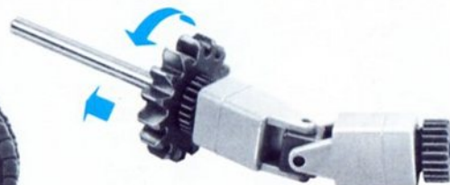
Bild 118 Das Zahnrad 15 Z als „Werkzeug“ zum Anziehen von Klemmverschraubungen
