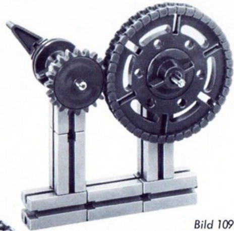
Bild 109–110 Bau von großen „Stirnzahnrädern“ mit Hilfe der Kette
