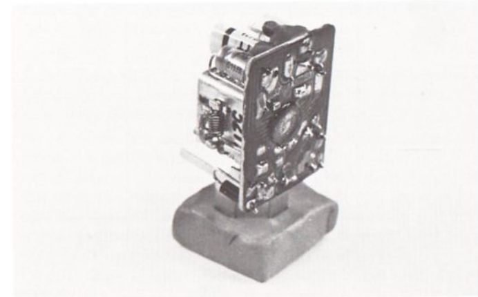
Abb. 5.4: Elektronischer Blinkgeber – in der Mitte der Frontplatte ist der rechteckige integrierte Schaltbaustein zu erkennen
