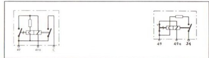
Abb. 5.2: Blinkgeber-Schaltungen für Dunkel- (links) und Hellbeginn (rechts)
