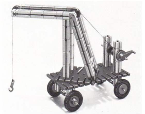
△ Abb. 3.7.35 Bei diesem drehbaren Kran ist die Seiltrommel an einer ungeeigneten Stelle angebracht. Sie läßt sich beim Drehen des Turms nicht mitdrehen. Das Seil springt deshalb leicht von der Führungsrolle.
