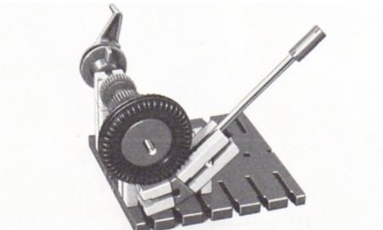
Abb. 3.7.34 Konstruktionsbeispiel einer Außenbackenbremse.
