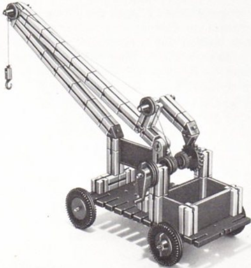
Abb. 3.7.11 Fahrbarer Kran mit starrem, abgestütztem Ausleger. Die Handkurbel dient zum Antreiben der Welle der Seiltrommel. Die Führung des Hubseils erfolgt durch Schnurlaufrollen. Die Sperrklinke verhindert ein ungewolltes Absinken der Last. Der Kasten aus Flachbausteinen kann die Gegengewichte aufnehmen, er dient gleichzeitig der Stabilisierung der Hubvorrichtung.
