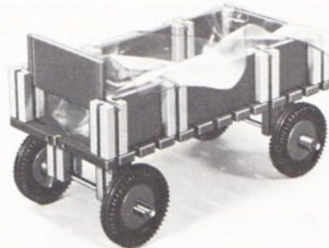
Abb. 3.2.3 Kastenwagen wie Abb. 3.2.5.1. Die Seitenteile können zum Entladen hochgeschoben werden.
