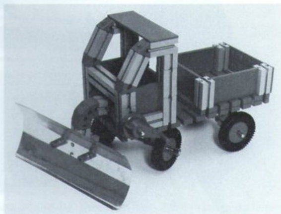
Abb. 27: Lenkbarer Lastwagen mit einseitigem Schneepflug. Der Schild besteht aus Aluminiumblech. Die Befestigung erfolgt in gleicher Weise wie bei Abb. 25. Der Räum schild kann mit einer Handkurbel angehoben werden; hierzu wurde die Kurbelachse durch einen Baustein 30 mit Bohrung geführt, auf welchen an beiden Seiten Seiltrommeln aufgesetzt wurden. Die Lagerreibung ist so groß, daß der angehobene Schild in jeder beliebigen Stellung stehen bleibt. Ein seitliches Schwenken des Räum schilds erfolgt durch Verdrehen des Pflugträgers.
