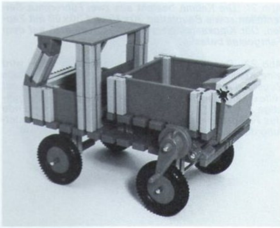
Abb.14: Kipplastwagen mit Frontlenkerkabine. Der Kippkasten wird wie bei Abb.13 mit einer Kurbelwelle angehoben. Die Rückwand des Kastens ist nach oben aufklappbar und öffnet sich selbsttätig beim Kippen.
