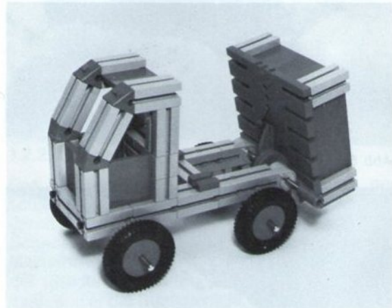
Abb. 12: Kipplasterwagen mit Frontlenkerkabine. Der Kasten wird durch Drehen an der seitlich etwas herausstehenden Achskupplung angehoben und gesenkt. Als Mitnehmer dient der Kurbelarm der eingebauten Handkurbel, deren Griff am Kastenboden festgebunden ist. Das Modell hat keine Lenkung.
