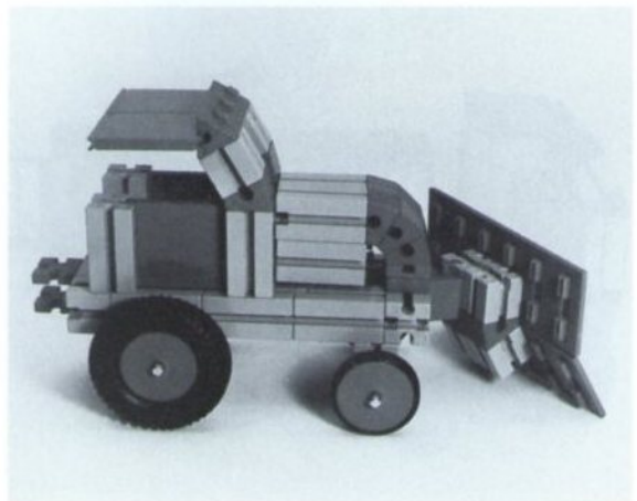
Abb. 24: Schlepper mit einseitigem Schneepflug. Der Räumschild ist bei diesem Modell starr am Fahrzeug befestigt.
