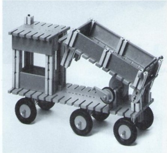
Abb. 42: Kipplaster, 2 Schüler, 3. Schuljahr Etwa dasselbe Konstruktionsniveau wie Abb. 41. Die Exzentrerscheibe schreibt wie die gekröpfte Welle eine hohe Lagerung des Kastens vor, die nicht zweckmäßig ist. Aber dieses Zugeständnis ist unvermeidlich, wenn für den Hebemechanismus die technisch elegantesten Konstruktionen (Welle, Exzenter) angewendet werden sollen. Das Modell wurde in einer Zweiergruppe gebaut. Auch an diesem Modell besticht die schnörkellose Sachlichkeit.
