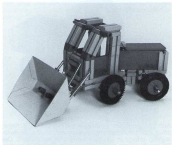
Abb. 36 und 37: Radlader mit Ladeschaufel aus Pappe. Das Fahrzeug ist mit einer Knicklenkung ausgestattet. Die Schaufel kann mit Hilfe eines Seilzugs angehoben und durch einen Handhebel (Abb. 37) gekippt werden. Das Zugseil ist mit Klemmbuchsen auf der Achse befestigt.
