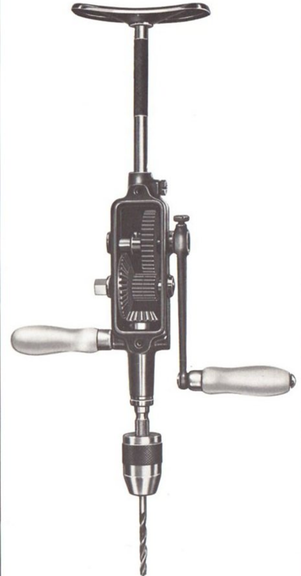
Technisch voorwerp waarbij de overbrenging van de rotatiebeweging naar een evenwijdige en een loodrechte as door tandwielen gebeurt.
