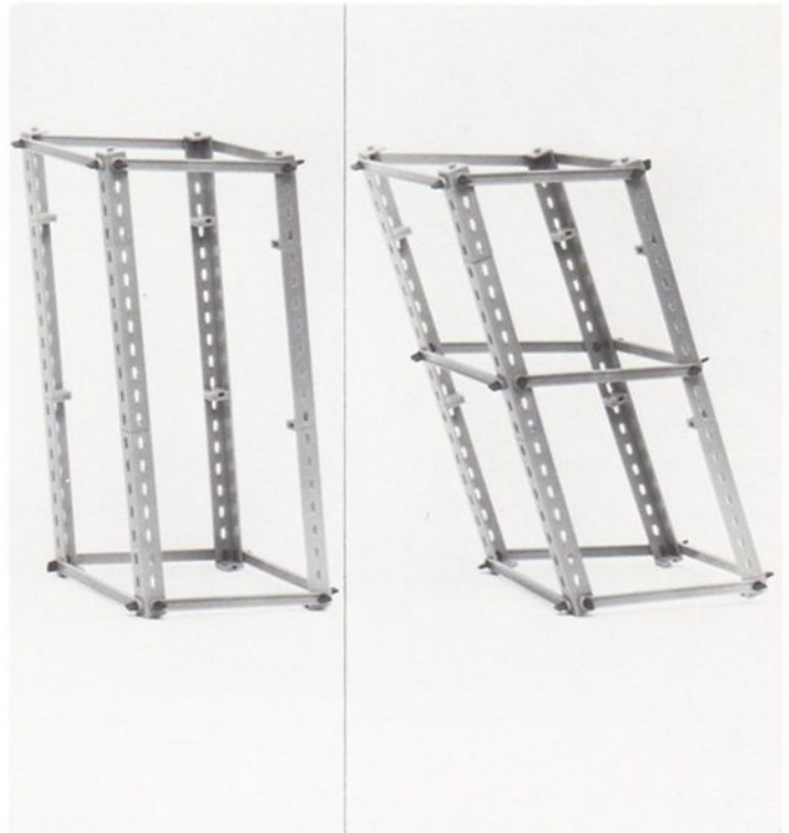
Abb. 18b) Auch dieses Modell aus Bauteilen des u-t S ist bei nur rechtwinkliger Anordnung noch instabil.
