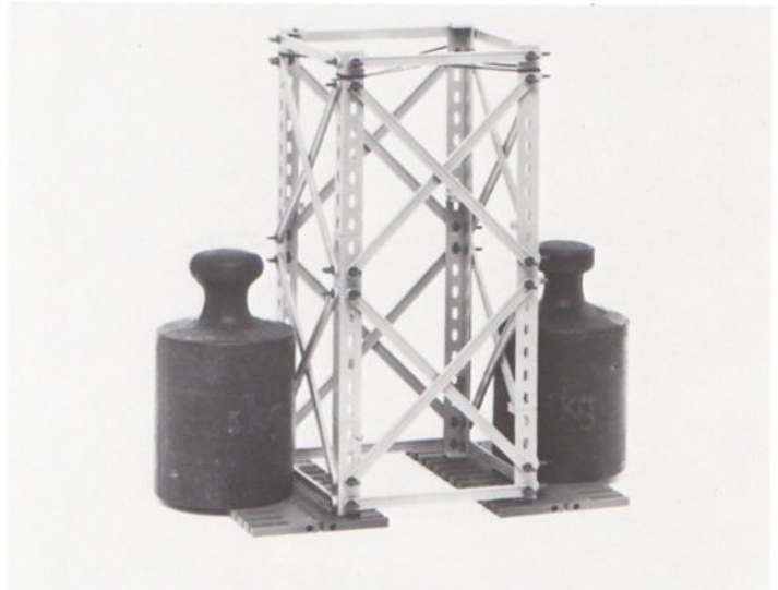
Abb. 22b) Oben angebrachte Diagonalverspannung mittels Schnüren erbringt eine optimale Stabilität.
