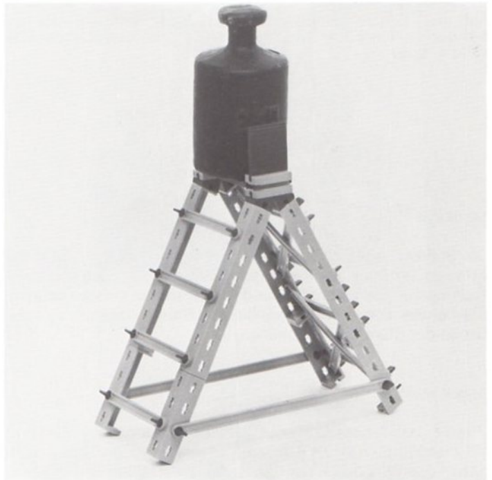
Abb. 17b) Durch die große Standfläche steht das Klettergerüst bei Druck in Längsrichtung viel stabiler.
