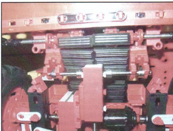
De stro-invoer-elevator direct achter het maaibord (foto van onderen genomen).
