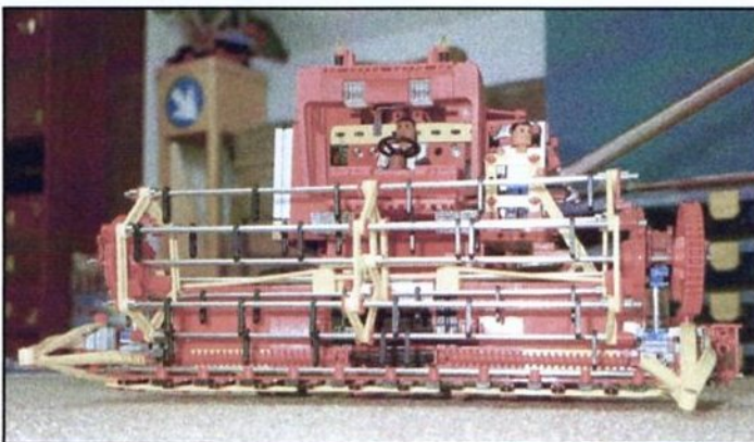
Messenbalk, draaiende haspel en verzamel-invoervijzel maken tesamen het maaibord.
