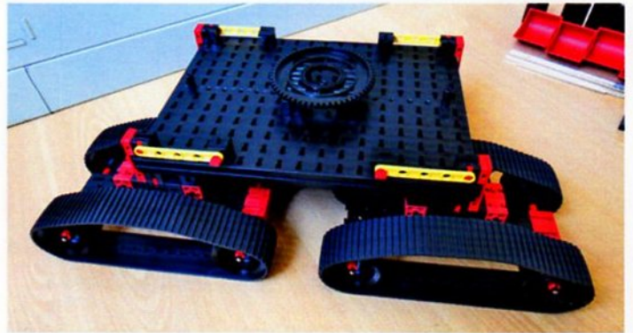
Das Untergestell mit Drehkranz ist fertig.
