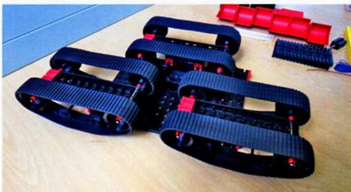
Das Untergestell mit den neuen Raupenbändern.
