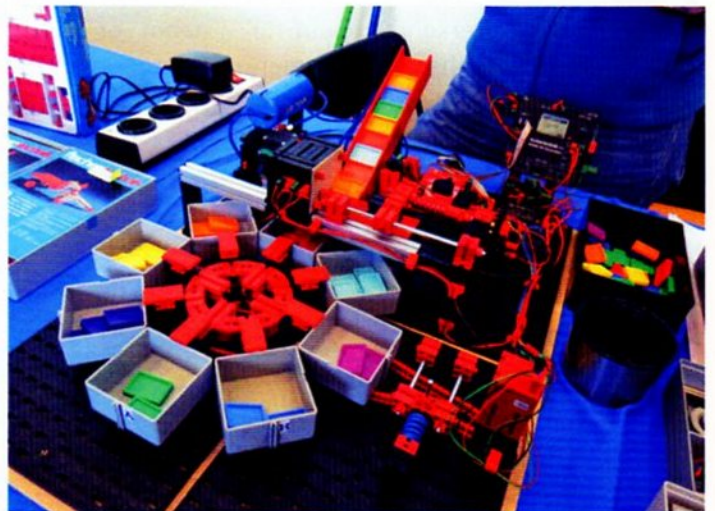
Sortiermaschine für gefärbte Dominosteine von Hans Wijnsouw.
