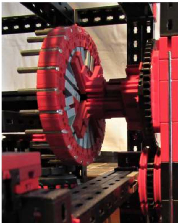
Foto 9a - Kammrad, Hauptbauteile, Winkelstein 15% (31981), Winkelstein 60% (31010), Baustein 15 (32881), Baustein 7,5 (37468), Bauplatte 30x15 1 Zapfen (35049), Winkelstein 10x15x15 (38423), Drehscheibe (31019), M-Achse 30mm. (31034)
