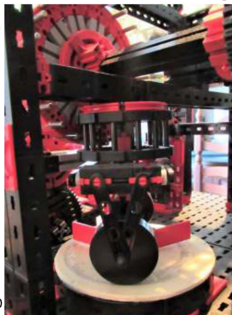
Foto 10 – Im Kollergang werden Produkte (Walnüsse) gemahlen.
