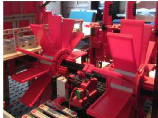
Foto 7 - Wassermühlenantrieb (Aluminiumwelle), Wasserrad 7 (Flachstein 31555)
