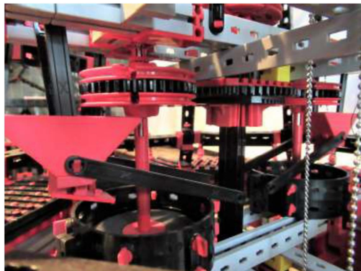
Foto 5 - Mühlsteinpaare. Die Kornbehälter (37353) bewegen sich durch Verbinden von 2 Streifen (36924) mit der Königswelle. Die Saatkörner werden zwischen die Steinpaare geleitet, um zu Mehl gemahlen zu werden.
