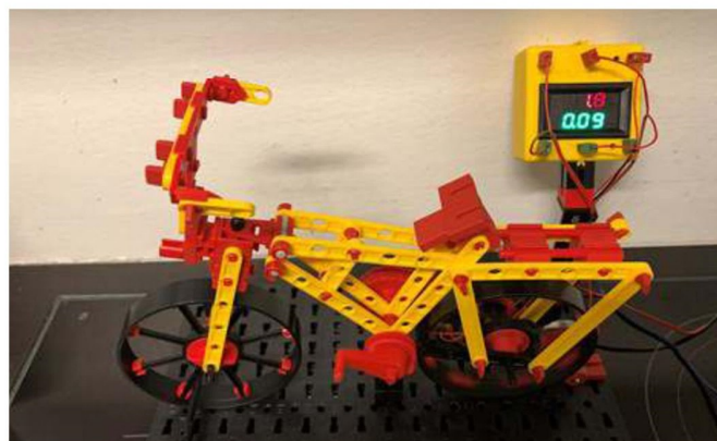
Foto links: LCD-Messgerät mit einer einzelnen Dezimalstelle in Stromanzeige beim Laden eines 8,4 V NiMH-ft-Akkus. Foto rechts: Das Niederspannungsmessgerät misst Spannung (1,8 V) über und Strom (90 mA) durch einen Solarmotor, der ein Fahrrad antreibt.
