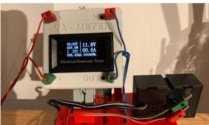
Foto links: LCD-Messgerät mit einer einzelnen Dezimalstelle in Stromanzeige beim Laden eines 8,4 V NiMH-ft-Akkus. Foto rechts: Das Niederspannungsmessgerät misst Spannung (1,8 V) über und Strom (90 mA) durch einen Solarmotor, der ein Fahrrad antreibt.
