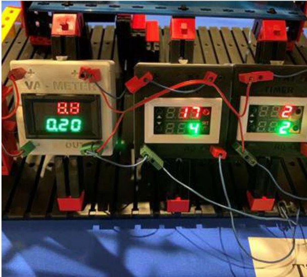
VA-Messgerät und zwei Timer, der Erste 21 Sekunden an, 4 aus, der Zweite 2 Sekunden an/aus, beide im Wiederholungsmodus
