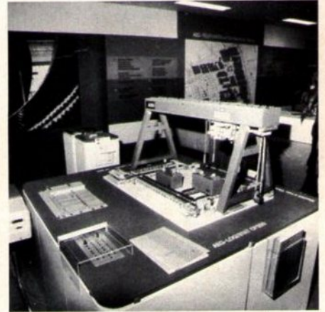
AEG demonstriert an seinem Messestand den neuesten Prozeßrechner LOGICOM 550 anhand eines Container-Umsetzkrans aus fischertechnik.
