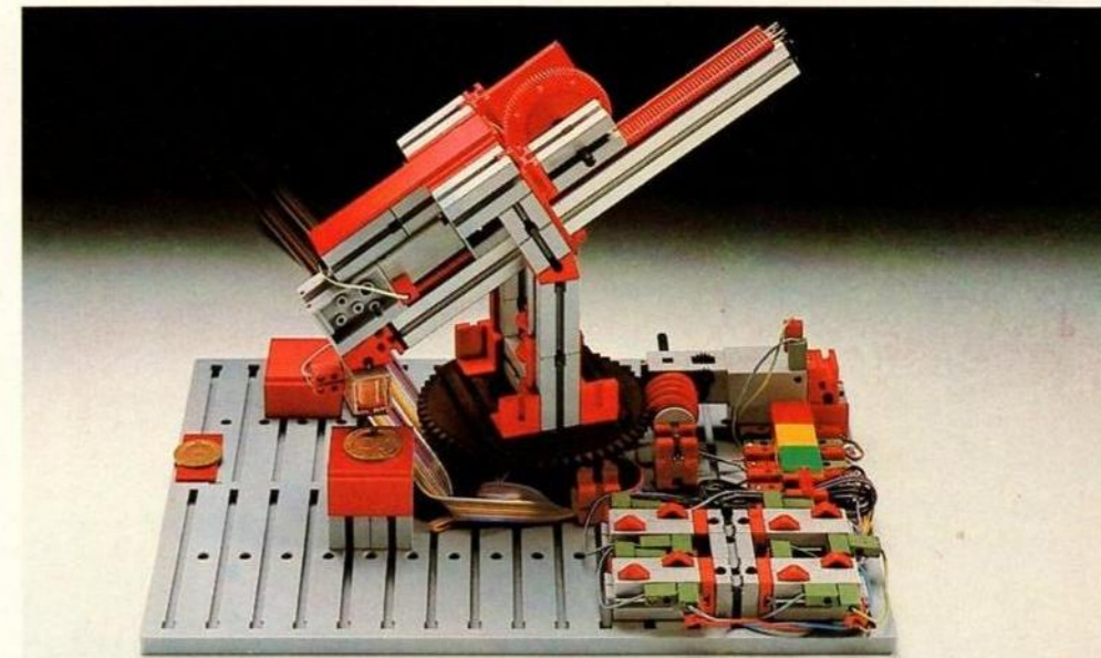
Teach-in Roboter Lernt Bewegungsabläufe und wiederholt sie selbständig.
