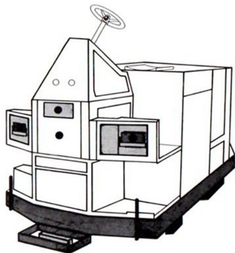
Bild 10.18: Industrieller Fahrroboter mit optischen und Ultraschall-Sensoren. Die Stoßstange und die Verkleidung sind teilweise entfernt. Die Lenkung dient nur dem manuellen Eingriff.
