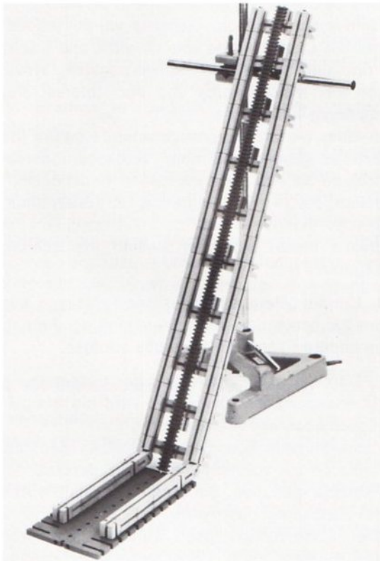
Abb. 5 Durch die Lagerung der Zahnstange an Stativmaterial kann die Neigung leicht variiert werden.
