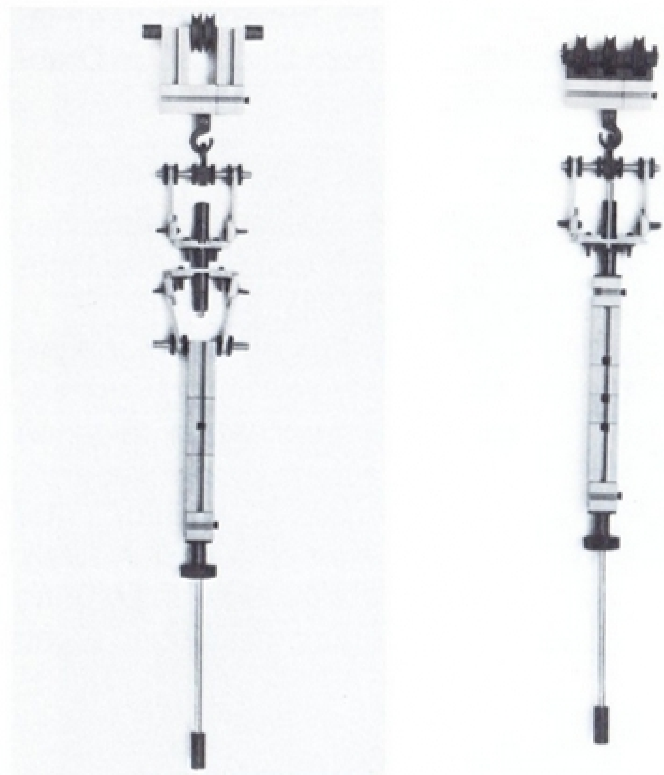
Abb. 7, 8: Übergang vom feststehenden Teil des Gerüsts zum Gestänge
