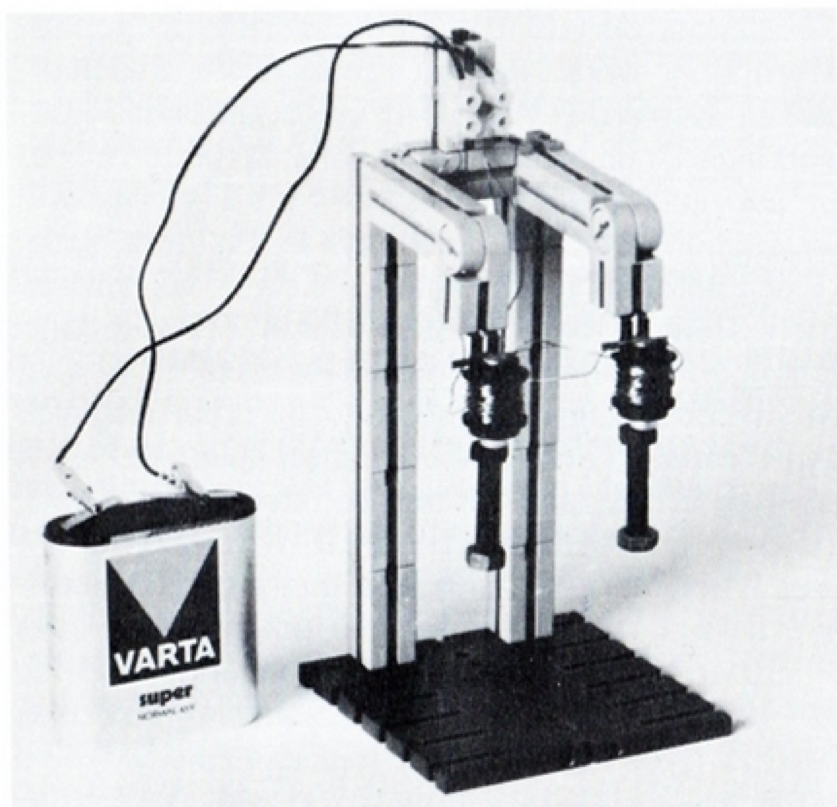
Abb. 4: Testgerät Elektromagnet (Altern. zu Abb. 3)
