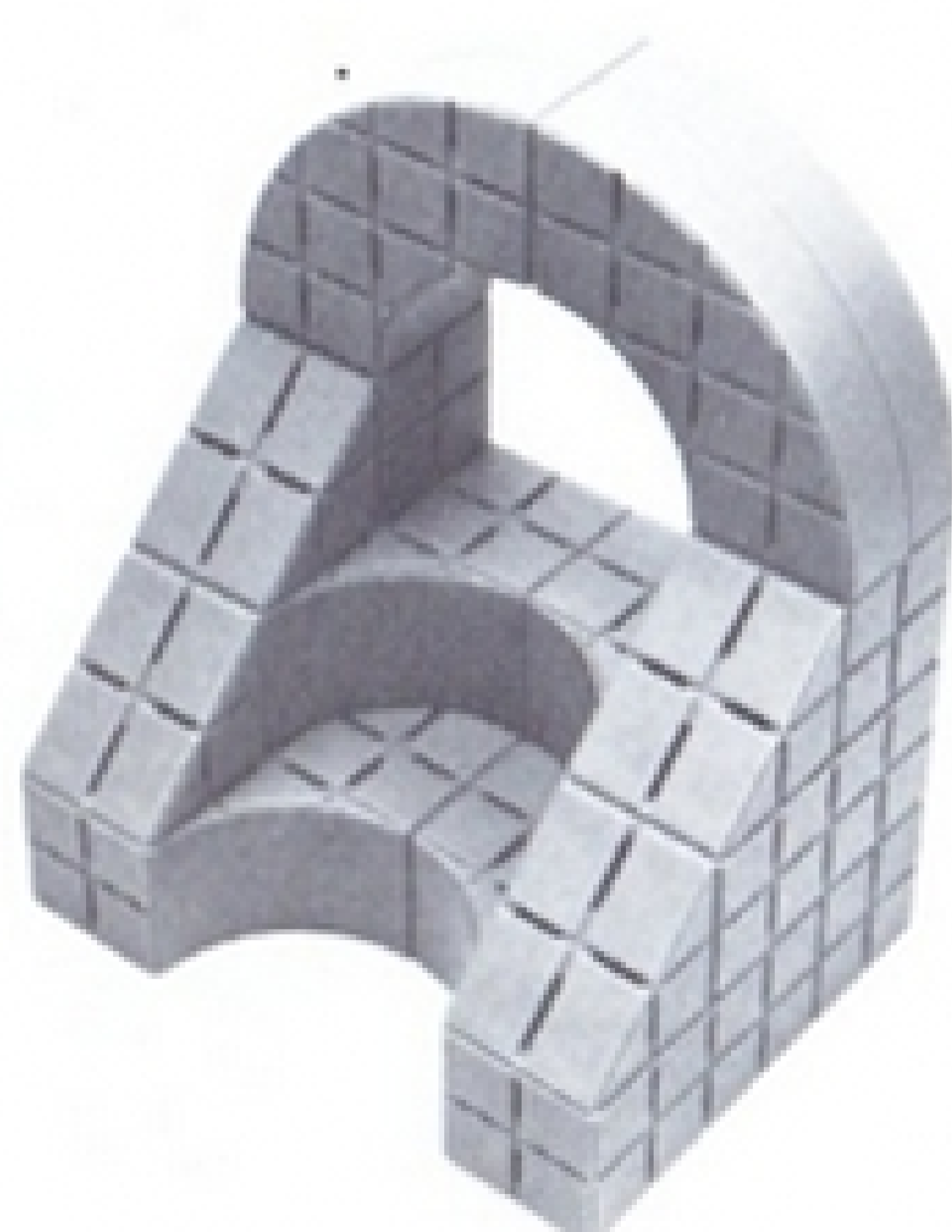
Körper, der sich zur Einführung der Darstellung im Vollschnitt eignet.
