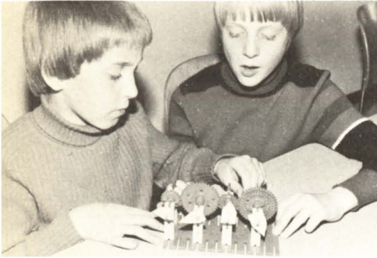
Abb. 15. Kartonzeiger machen Änderungen der Drehrichtung und -geschwindigkeit deutlich
