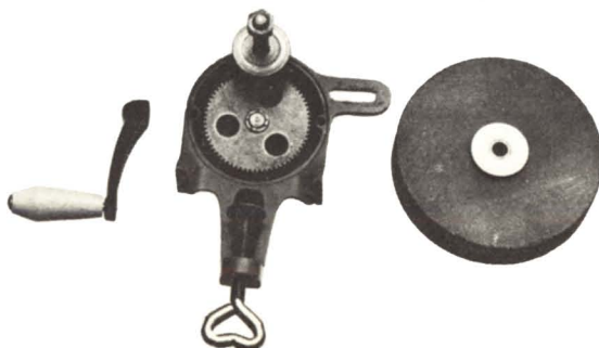
Abb. 6: Schleifmaschine; Übersetzung ins Schnelle
