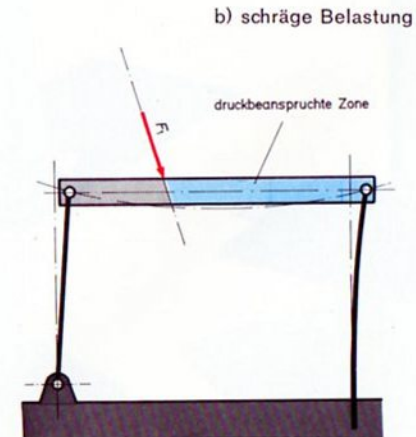
Dreigelenkträger des Modells 24.1
