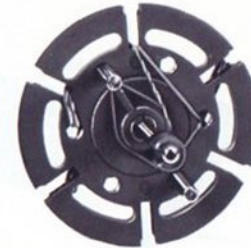
70.3 Rückseite der Mitnehmer-Scheibe 1 oder 2 Gummiringe so befestigen, daß die Mitnehmer weich federn!
