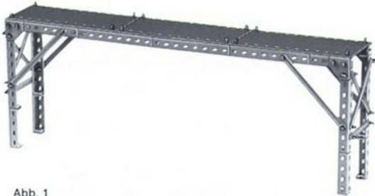
Abb. 1 Brücke mit Pfeilern aus Winkelträgern, erster Bauversuch
