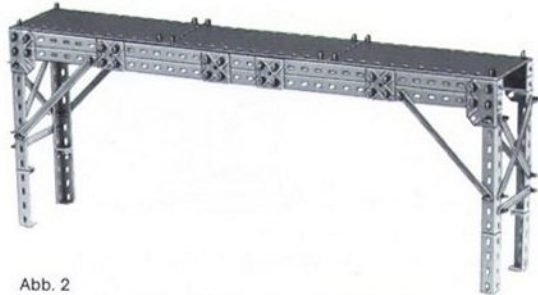
Abb. 2 Verbesserte, stabilere Brücke, ohne ausreichende Durchfahrtsbreite und -höhe
