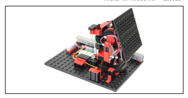
Das Modell Kompakt-Sonnennachführsystem simuliert ein schwenk- und drehbares Trägersystem für Solaranlagen, wie es beispielsweise in der Stromerzeugung aus Sonnenenergie in Sonnenparks eingesetzt wird. Das Kompakt-Sonnennachführsystem besteht aus einem horizontal schwenkbaren Paneel und einer drehbaren Säulenhalterung.
